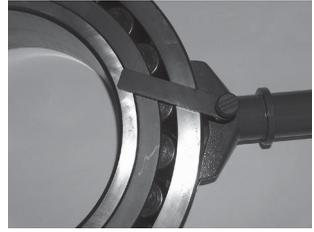
내경고정대는 베어링의 같은 면에 배치되어야 합니다. 내경고정대가 내륜의 보어에 위치하거나 케이지 또는 롤러에 대해 배치되지 않았는지 확인하십시오. 내경고정대를 잘못 배치하면 베어링이 손상되거나 베어링이 샤프트에 장착되기 어려워 집니다.
